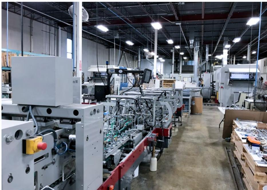
lestimento minimi e un alto grado di produttività e redditività. Le macchine piega-incolla Allpro producono confezioni lineari, a doppia onda, con fondo automatico e a 4 e 6 angoli, nonché, in via opzionale, divisori interni, scatole con fondo automatico coniche e piegate a Z e confezioni per CD con velocità fino a 400 m/min. Tutte le macchine piega-incolla Omega sono equipaggiate con comando touchscreen e router per manutenzione remota e sono concepite per essere robuste e affidabili.
