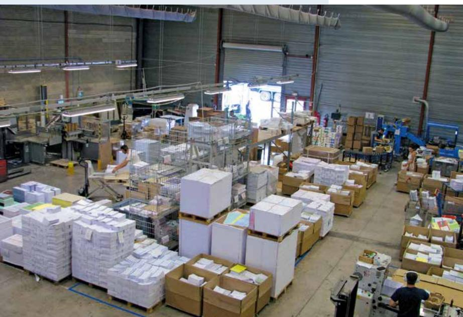
**Die Weiterverarbeitungshalle umfasst neben mehreren Falzmaschinen und Stanzmaschinen auch einen Sammelhefter der Marke Müller Martini, sowie Maschinen zum Nummerieren, Rillen und Verpacken der Drucksachen**
