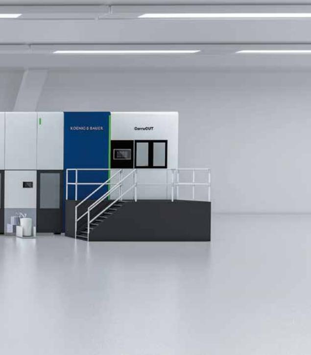
ten Druckqualität bietet sie beim Drucken und Stanzen eine sehr hohe Passgenauigkeit; das reduziert den Abfall signifikant und stärkt die Ressourceneffizienz. Mit einer Arbeitsbreite von 2,80 Meter und 12.000 Einschüben pro Stunde ist die CorruCUT extrem leistungsfähig; außerdem lassen sich so auch großformatige Verpackungen und Displays leichter herstellen.
