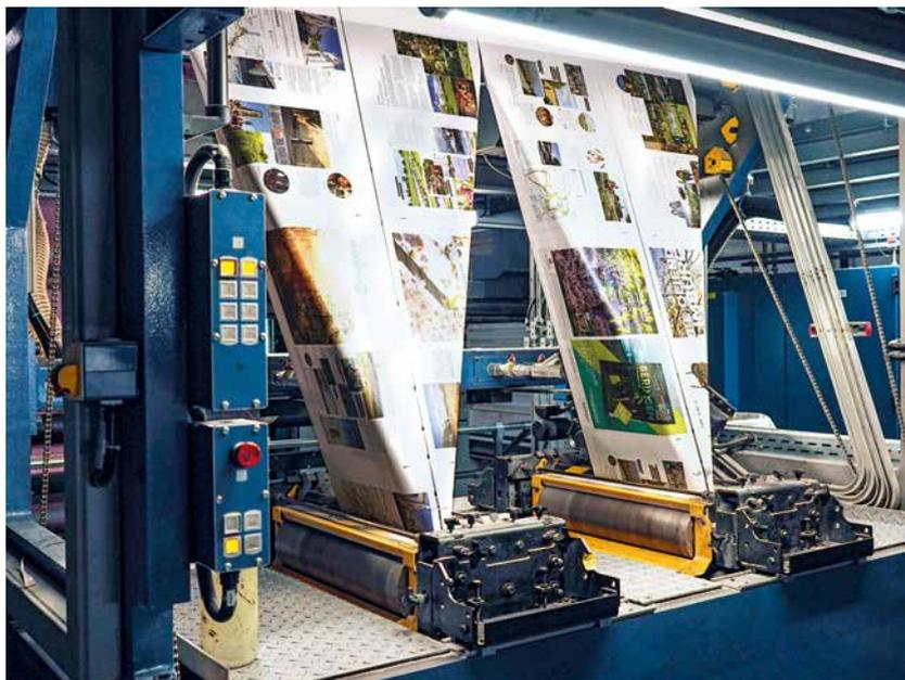
Im April 2017 wurde bei Coldset Printing Partners mit dem elektrischen und mechanischen Retrofit der sieben Drucktürme und drei Falzapparate begonnen, die in die neue Konfiguration übernommen wurden. Der einzig kritische Punkt aus Sicht des Kunden war der Umzug einer der vier Commander-Falzapparate ans andere Ende der Maschinenlinie. Dafür waren Ende Januar/Anfang Februar 2018 vier Wochen
