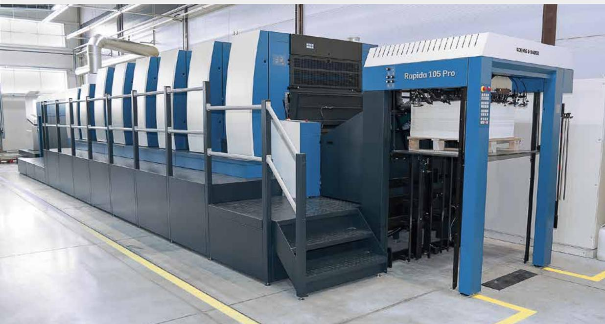
La nouvelle Rapida 105 PRO six couleurs avec tour de vernissage, sortie rallongée et changeurs automatiques de plaques FAPC a été installée dans des locaux flambant neufs.
