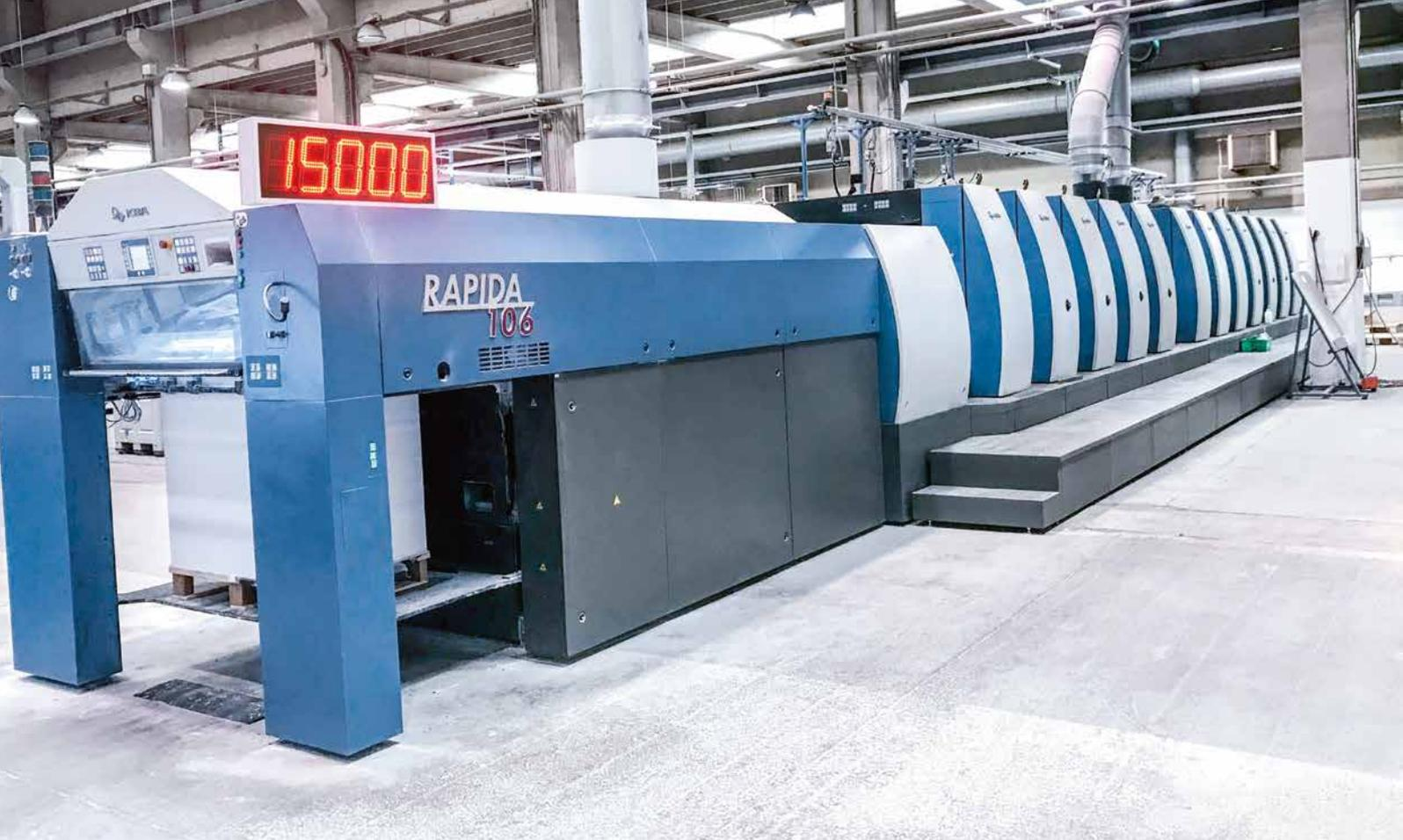
**Dotée de huit groupes imprimants et du contrôle couleur en ligne QualiTronic ColorControl, la Rapida 106-4+LTT+4+L SW7 très automatisée de Koenig & Bauer permet d'imprimer et de vernir sur le recto comme sur le verso en un seul passage jusqu'à 15 000 f/h.**
