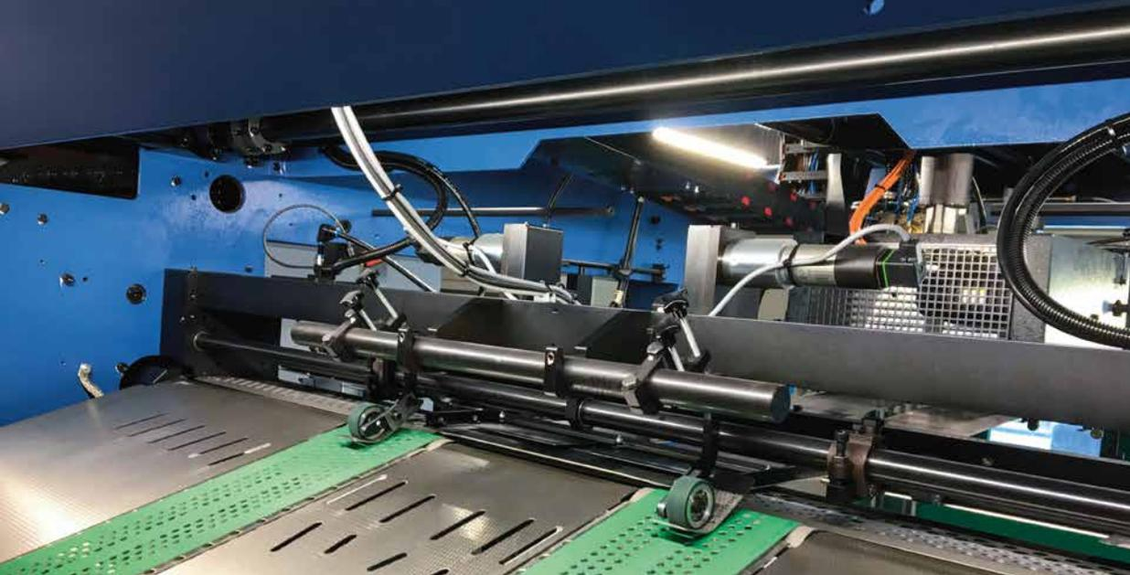
À l'arrière-plan, l'une des commandes individuelles du margeur DriveTronic.
