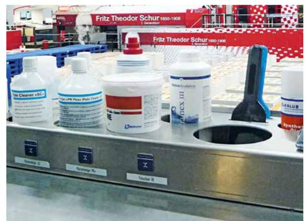
**Die Ablage für Verbrauchsmaterial ist an jeder Rapida-Maschine getagt**
