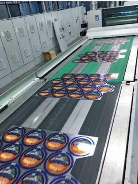
**Materialeinsparungen haben höchste Priorität beim Metalldruck. Hier werden Scroll Tafeln bedruckt und lackiert. Diese Tafeln sind ausgestanzt um das Material optimal auszunutzen**
