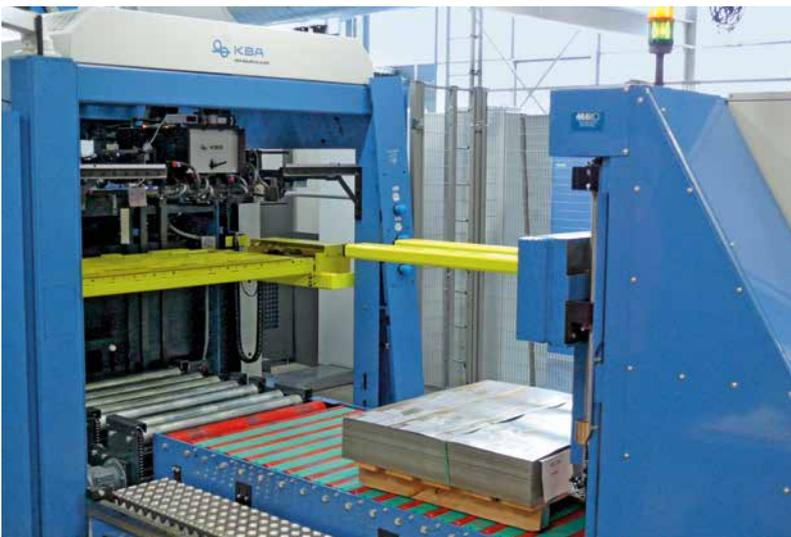
**Der automatische Palettenwechsler der MetalStar 3**
