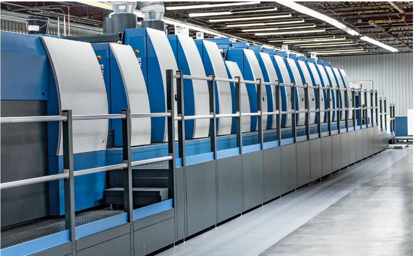
Im Frühjahr nahm Curtis eine neue Rapida 106-Elffarben-Doppellackmaschine mit einem Druckwerk nach der Lackierung in Betrieb. Sie wurde neben zwei Rapida 130 installiert, und ersetzt jetzt eine weitere Rapida 130. Mit der neuen Maschine, ihren Innovationen und ihrer fortschrittlichen Technologien sollen durch den gezielten Einsatz hochwertiger Inline-Veredelungstechnologien signifikante Wachstumsraten erzielt werden.
