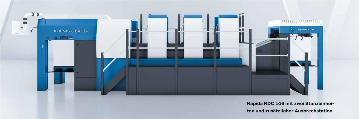
Rapida RDC 106 mit zwei Stanzeinheiten und zusätzlicher Ausbrechstation
