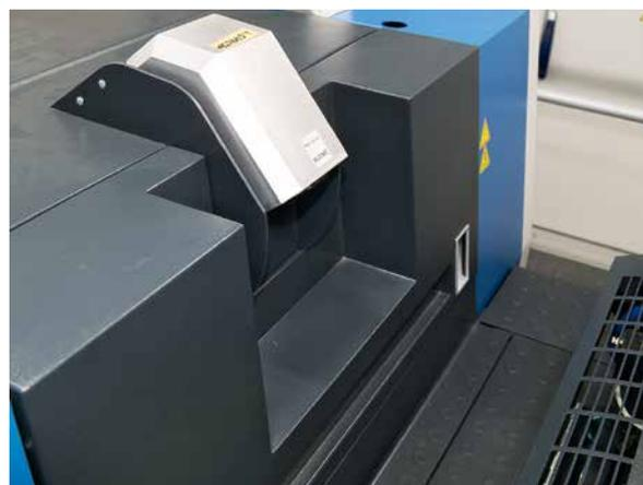
**La regolazione dell'inchiostro in linea con il QualiTronic ColorControl è una delle principali caratteristiche della dotazione della macchina**
