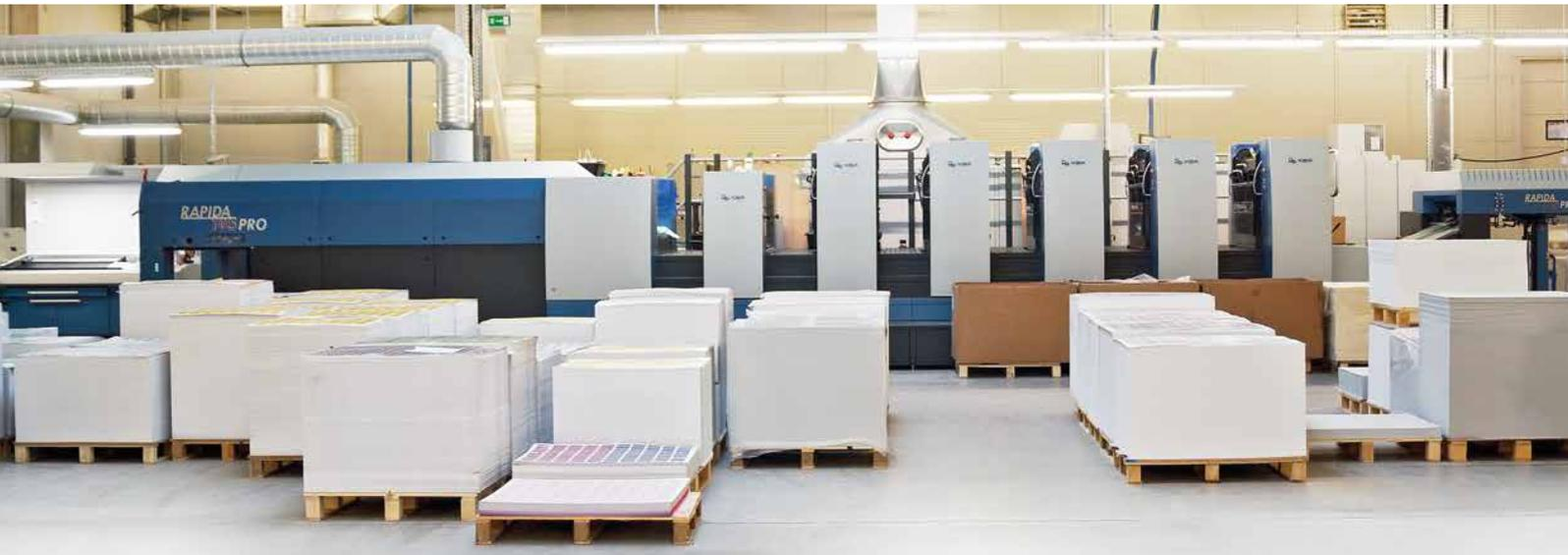
**Mittelpunkt im Drucksaal: die neue Fünffarben-Rapida 105 PRO mit Lackturm und Auslageverlängerung**
