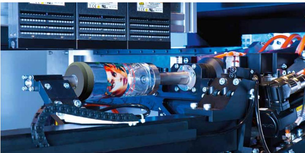
Das piezoelektrische, sogenannte „Drop-on-Demand“-Verfahren (DOD; Deutsch: Tropfen auf Anforderung) ist eine Drucktechnik, bei der die Düsen eines Druckkopfes für jeden einzelnen Tintentropfen des Schriftbildes geöffnet werden. Das heißt es werden nur Tintentropfen ausgestoßen, wenn sie tatsächlich benötigt werden. Der einzelne Tintentropfen, der auf die Artikeloberfläche geschossen
