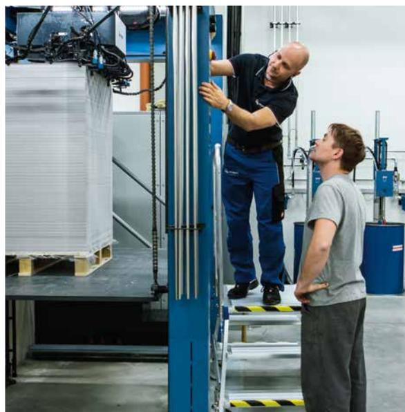
**Für die Kartonagenproduktion ist die Rapida 164 höher gesetzt. Am Anleger ist die mögliche Stapelhöhe besonders gut erkennbar**
