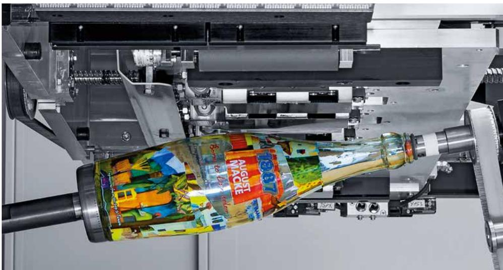
mehrfach verfahren. Die entsprechenden Übergänge „unsichtbar“ zu gestalten, soll in Kürze software-technisch machbar sein. Eine Alternative ist der „spiralförmige“ Druck, der ein perfektes Zusammenspiel aus Software, Inkjetköpfen und Artikeltransport voraussetzt.
