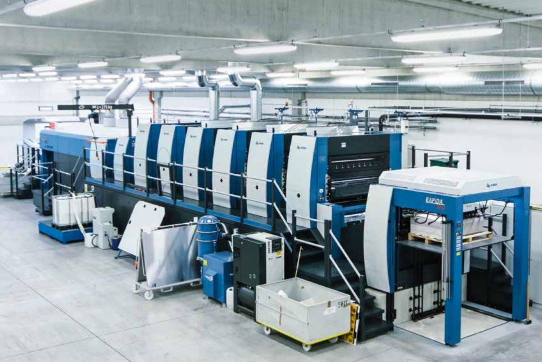
Insbesondere die Funktion der Farbmessung und -regelung mit QualiTronic ColorControl und QualiTronic PDFCheck (beide mit demselben Kamerasystem) schätzen die Fachleute in Jílové sehr. QualiTronic PDFCheck vergleicht die bedruckten Bogen mit den PDFs aus der Druckvorstufe und kennzeichnet Abweichungen in den verglichenen Druckbogen. Vorteil von QualiTronic PDFCheck ist die Auswertung der Druckqualität noch vor Beginn des Auflagedrucks.
