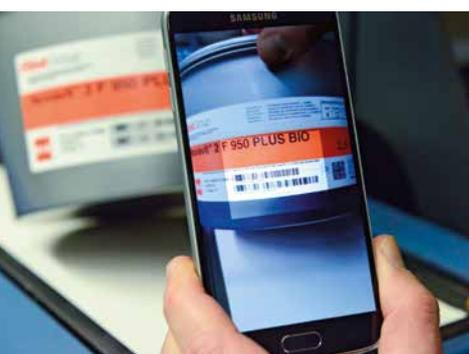
**Einscannen des Chargencodes der Farbe direkt am Verbrauchsort – d. h. an dem Druckwerk, an dem es zum Einsatz kommt**
