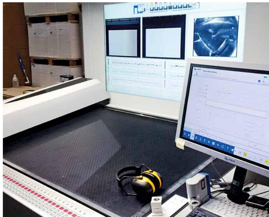
mé par jet d'encre sur les feuilles. QualiTronic PDFCheck ou QualiTronic PDF HighRes détectent les feuilles défectueuses, les affectent au numéro d'identification et les indiquent dans le rapport de pile. Elles peuvent ensuite être prélevées manuellement dans la pile.
