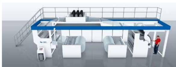
Le film est ensuite guidé par un rouleau tracteur aspirant à travers un sécheur placé en aval (uniquement dans le cas de vernis à solvants), passe sur un jeu de rouleaux motorisé et un rouleau de refroidissement pour arriver dans le dispositif à rayonnement excimère ou UV du fabricant IOT Leipzig, qui permet d'obtenir l'effet matifiant désiré. Le film est ensuite réenroulé sur une bobine.
