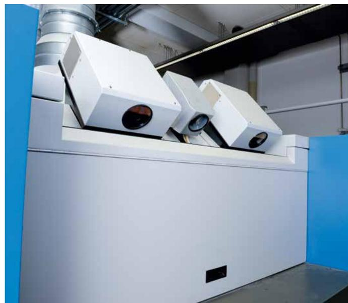
utilisateurs. Ce système d'inspection des feuilles est avant tout destiné aux fabricants d'emballages ou de notices pharmaceutiques nécessitant une résolution jusqu'à 300 dpi. Tandis que les deux autres systèmes font appel à des caméras couleur, QualiTronic PDF HighRes utilise deux caméras noir et blanc avec une résolution quatre fois supérieure, ce qui en fait le seul système en ligne du marché capable de répondre sans réserve aux très hautes exigences de l'industrie pharmaceutique.
