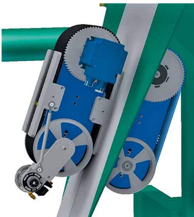
**Agrafeuse latérale pour agrafage broadsheet sur le cône de pliage.**
