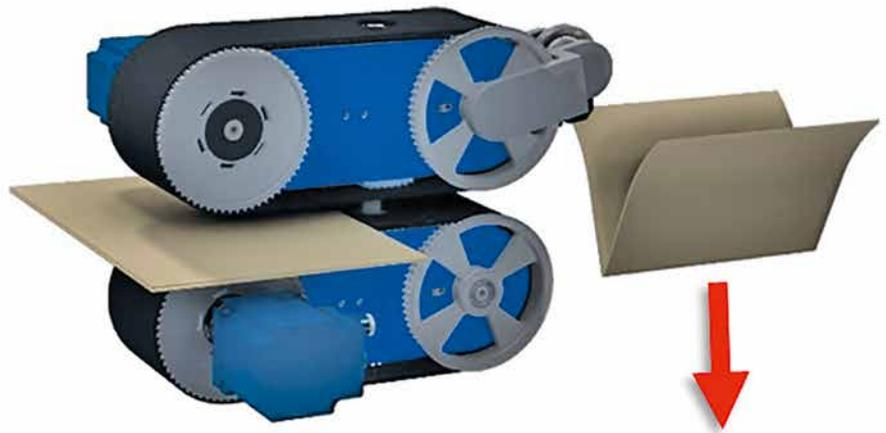
guidage des rubans a été adapté sur la plieuse KF 80 dotée d'un module pour pli d'équerre installé par Koenig & Bauer en 2015, et une agrafeuse latérale a été ajoutée.
