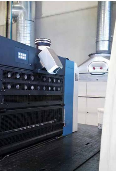
Les fonctions de contrôle du registre en ligne restent identiques : la mesure et la régulation du registre sont assurées par QualiTronic ICR et restent indépendantes de QualiTronic 2.
