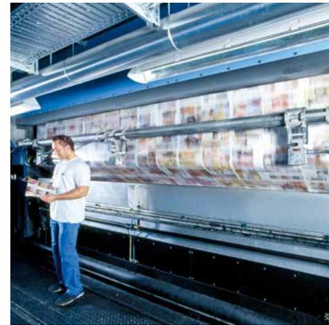
**Rotative hélio TR 12 B avec une laize de 4,32 m fabriquée à l'usine de Frankenthal en 2004.**
