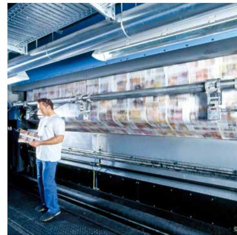
**Tiefdruckrotation TR 12 B mit 4,32 m Papierbahnbreite aus dem Werk Frankenthal 2004**
