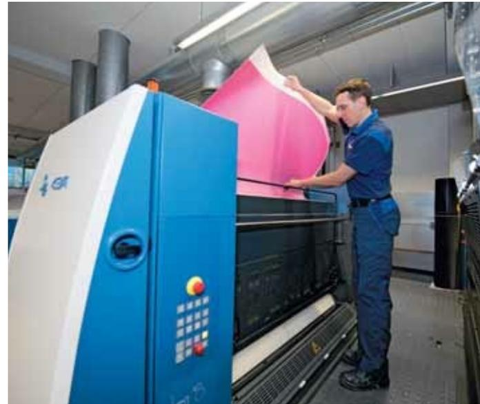
**Links: Die ziehmarkenfreie Anlage DriveTronic SIS arbeitet komplett bedienerfrei und zählt zu den praxisorientierten Innovationen für mehr Arbeitssicherheit**
