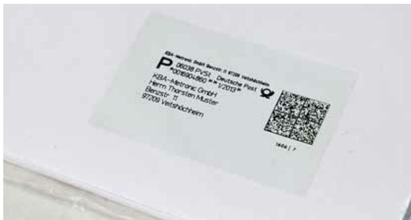
**Nach der Verpackung in einen Umschlag durch die Folie in das lasersensitive Adressfeld eingelassene Adresse**
