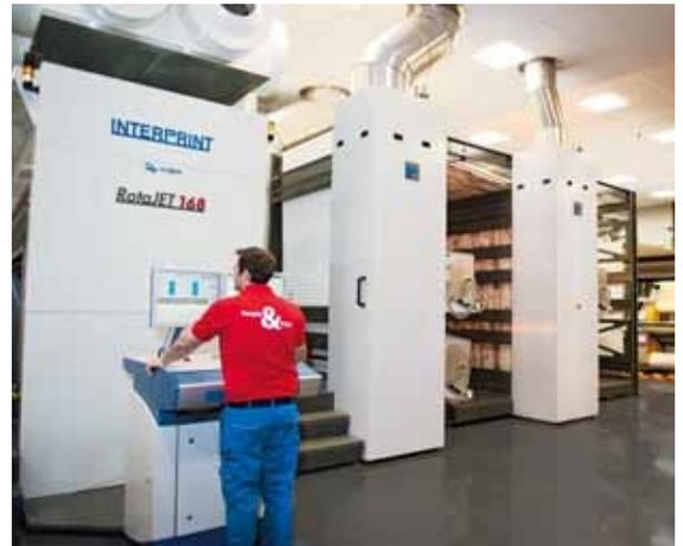
Mit der seit einem Jahr erfolgreich beim Dekordrucker Interprint in Arnsberg produzierenden RotaJET 168 schuf KBA Digital & Web eine neue, ausgesprochen flexible Maschinenplattform für kommerzielle und industrielle Digitaldruckmärkte. Das technische Konzept wurde auf die RotaJET L- und VL-Serien übertragen
