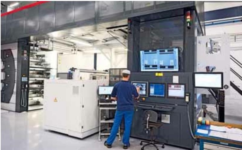
man mithilfe eines Kunststoffadapters die Sleeves und Rasterwalzen einfach, sicher und schnell aus der Maschine holen und auswechseln kann. Ein anderes, wichtiges Detail: Zur Erfüllung der Anforderungen an die Lebensmittelsicherheit muss die Farbe ruhig trocknen können. Dabei hilft die Trommel mit einem Durchmesser von 2,40 m, denn zwischen den einzelnen Farben entsteht mehr Platz. Hinzu kommen die hoch effizienten Trockner von KBA-Flexotecnica.“
