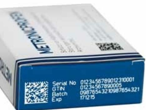
Links oben: Mit dem Thermo-Inkjet-System betaJET rückverfolgbar gekennzeichnete Pharmaverpackung
