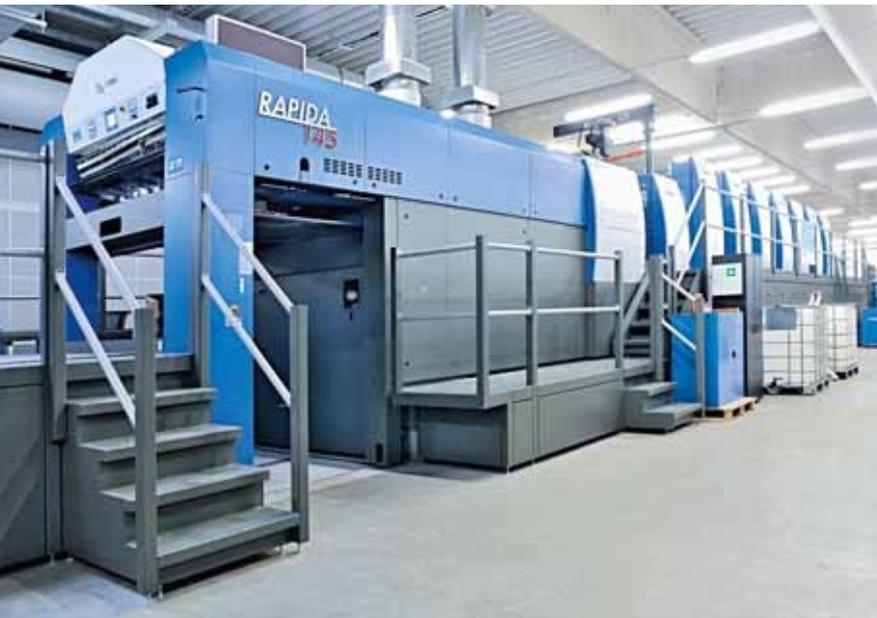
Die Siebenfarben-Rapida 145 mit Lackturm ist der produktive Mittelpunkt in der modernen Fertigungshalle von Pokart
