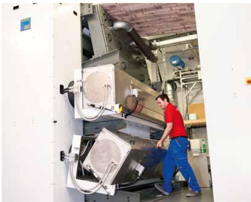
Deux sécheurs hybrides pivotants (IR/air chaud) après l'impression.
