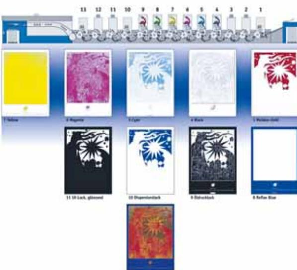
Fig. 3 : Configurée pour la dépose de vernis métalliques suivie d'un ennoblement hybride : la Rapida 105 LTT+6+LTLT avec sortie rallongée double et la séparation des encres et vernis, illustrée par une planche du calendrier KBA 2007.
