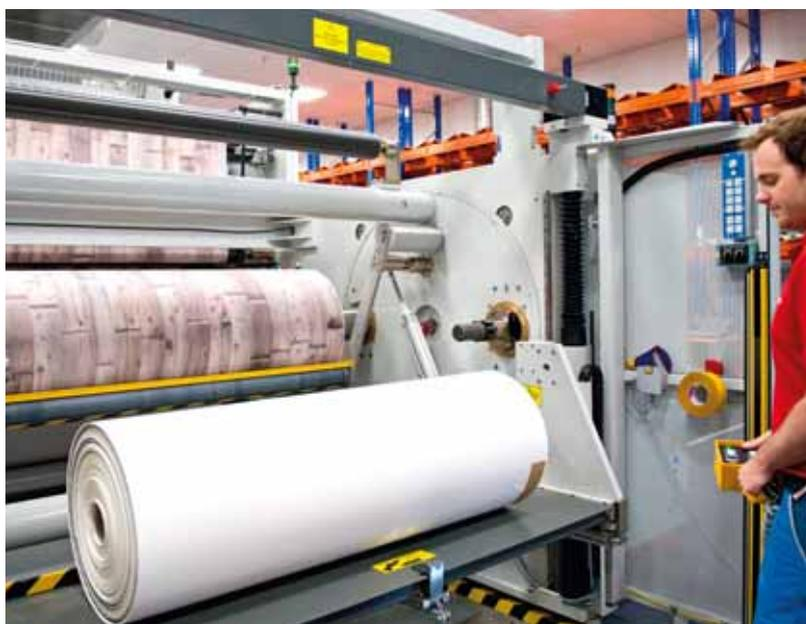
Les bobines imprimées sont retirées du réenrouleur sans interruption de la production.
