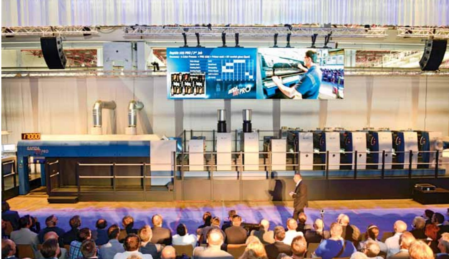
Rapida 75 cinq couleurs de la nouvelle génération avec tour de vernis et sécheurs LED. Cette présentation a mis en lumière l'excellente qualité d'impression et la plus grande brillance permise par la technologie LED-UV sur papier offset.
