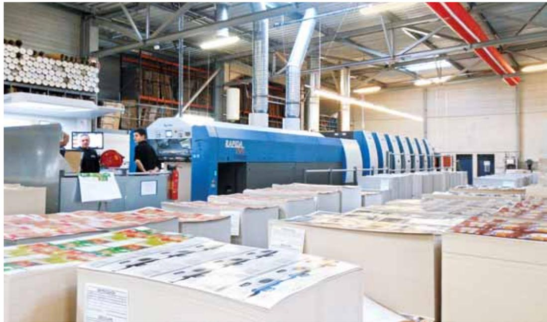
**Imprimant jusqu'à 20 000 f/h, et plus de 100 000 feuilles par équipe, la nouvelle Rapida 106 met le façonnage et le service expédition au défi.**
