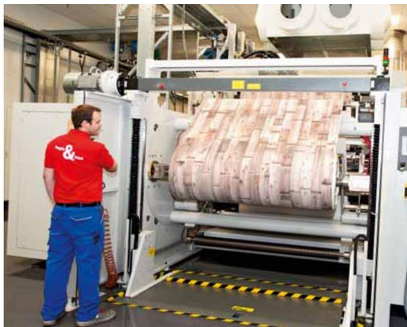
En haut : l'insertion automatique de la bande de papier est l'un des atouts de la KBA RotaJET pour l'impression industrielle.
