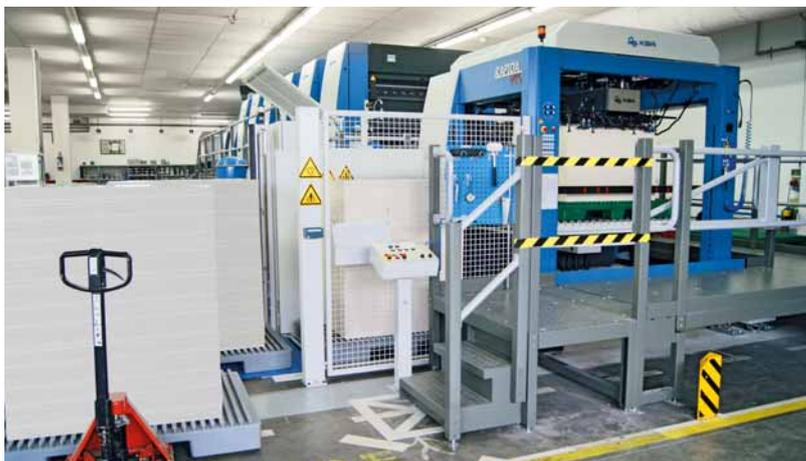
La nouvelle Rapida 145 de Model Obaly à Opava est rehaussée et dotée d'un système de logistique des piles automatisé (ici à la réception).
