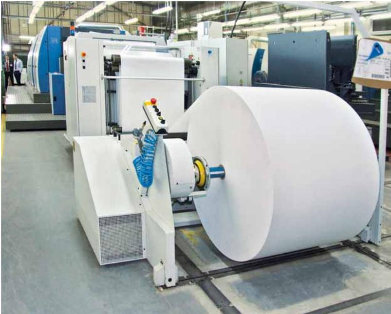
Un dispositif bobine-feuilles a été installé a posteriori sur la Rapida 106 six couleurs installée en 2010.
