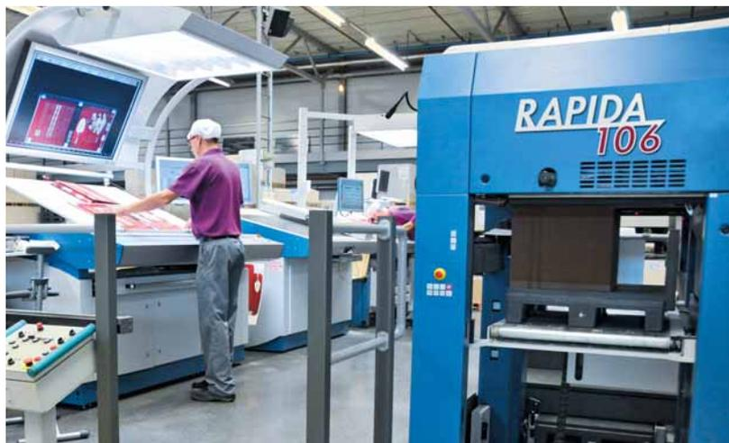
**Logistique automatisée des palettes à la réception :** les palettes pour les piles suivantes sont acheminées du margeur à la réception sous la machine.
