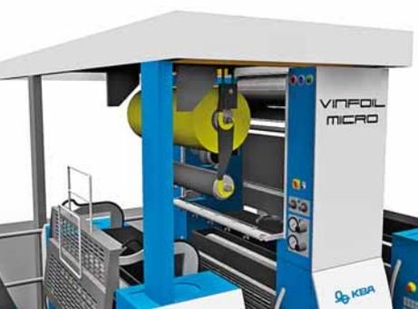
**Sinistra:** Una gru con telecomando permette di sostituire la pellicola in modo rapido ed ergonomico
