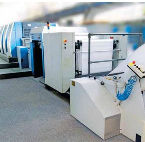
La Rapida 106-8-SW4 avec margeur bobine-feuilles RS 106 permet des temps de passage bien plus rapides que les margeurs feuilles classiques.
