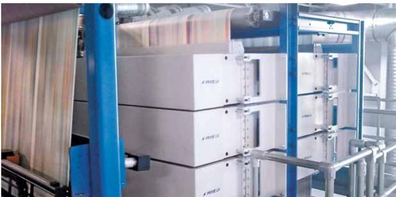
**L'une des trois tours d'impression est équipée d'un dispositif UV Prime permettant de réaliser des produits de type labour. Photo : Sam Wagner Web Offset Service**
