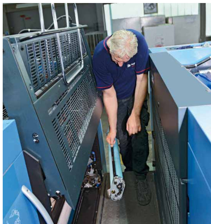
La consommation de tissu de lavage est indiquée sur le pupitre. Hubert Bauer et ses collègues peuvent ainsi planifier précisément le remplacement du tissu de lavage
