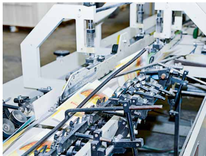
Trois lignes modernes pour la production de boîtes pliantes assurent le façonnage rapide des produits. Elles sont dotées de divers équipements spéciaux permettant de donner une dernière touche à la grande variété de produits finis fabriqués
