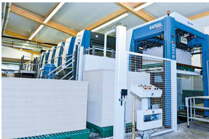
La Rapida rehaussée est intégrée dans une logistique automatisée
