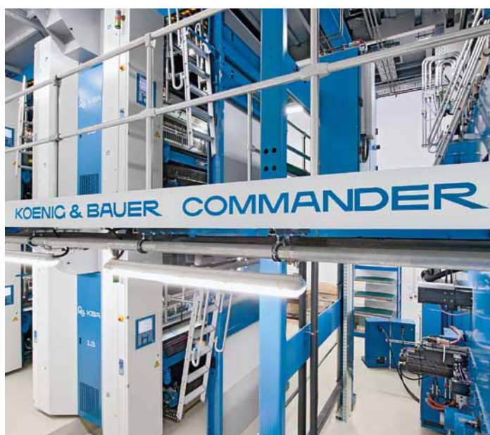
La conception modulaire de la KBA Commander CL permet un équipement personnalisé ainsi que des extensions ultérieures en fonction des exigences de la production
