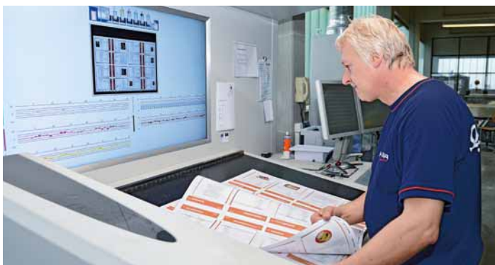
Le nouveau pupitre KBA ErgoTronic permet au conducteur Hubert Bauer de surveiller en permanence toutes les fonctions de la machine
