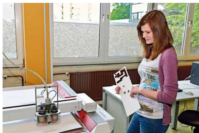
Grâce au traceur de découpe, il est possible de réaliser des échantillons de présentation avant le tirage principal
