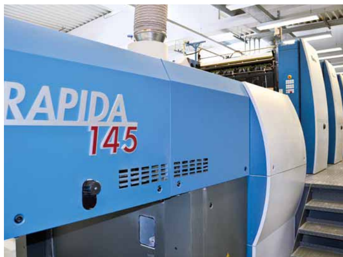
La presse huit couleurs à retournement de Himmer à Augsburg imprime essentiellement des livres, catalogues et affiches en quadri
