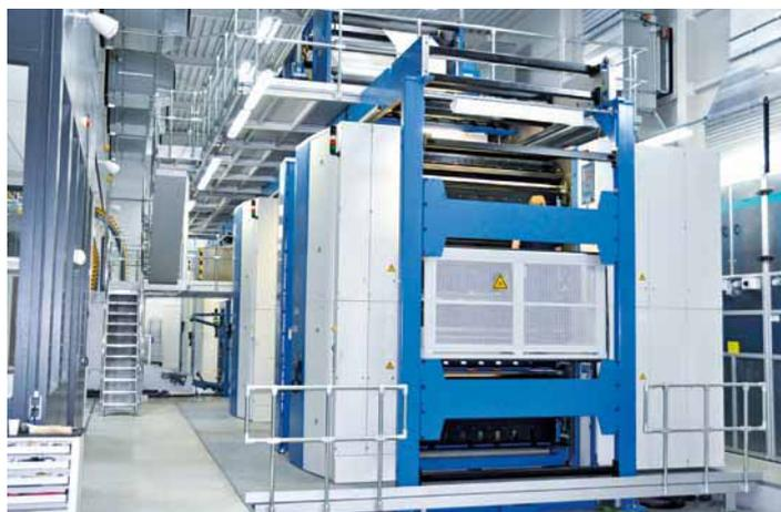
Die Commander CT verfügt über vier Achtertürme in 6/2-Konfiguration für bis zu 96 Seiten im Tabloidformat und einen mittig platzierten Klappenfalzapparat
