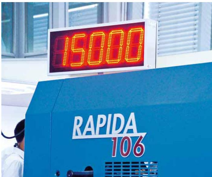
Weltrekordverdächtig! Die ColdFoil Infigo SF110 erlaubt an der Rapida 106 bei der Kaltfolienveredelung Produktionsgeschwindigkeiten bis 15.000 Bogen/h
