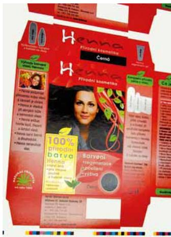
Oben: Fotorealistischer Bilderdruck mit gerasterten und überdruckten Goldfoliensujet
