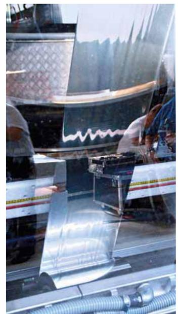
Die Rollenabwicklung und -verklebung erfolgt im leicht zugänglichen Seitenteil der ColdFoil Infigo SF110
