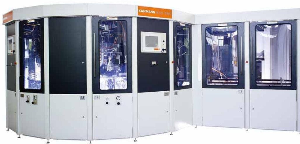
Siebdruckanlage der Kammann GmbH für die Direktdekoratation von Glas-, Kunststoff- und Metallbehältern der Premium-Klasse
