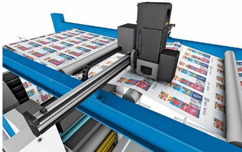
**Inkjet-Retrofit:** Traverse mit Kodak Prosper S30 Inkjet-Eindrucktechnik und Kamerasystem im Überbau einer KBA-Offsetrotation. Die Abbildung zeigt die Standardvariante mit einem Druckkopf. Auch zwei oder mehrere Druckköpfe für eine größere Eindrucksfläche oder eine höhere Fortdruckleistung sind möglich
