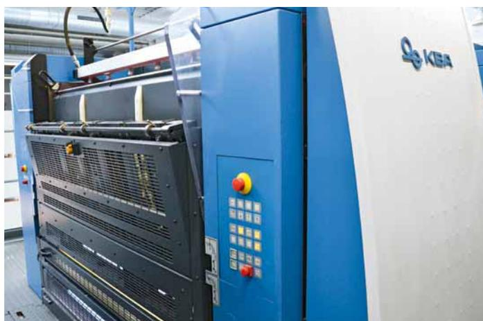
Rüstzeitweltmeister im Großformat: Dank Einzelantriebstechnik DriveTronic SPC können alle Platten in den acht Druckwerken gleichzeitig in 1:40 Minuten gewechselt werden. Der parallel ablaufende Waschvorgang mit CleanTronic Synchro trägt zu kurzen Rüstzeiten bei
