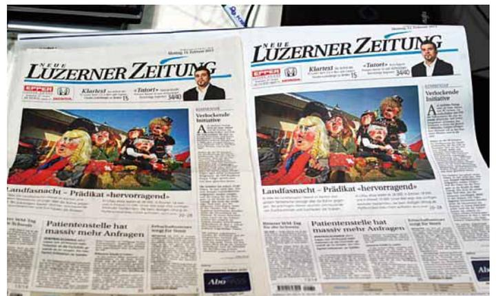
Anlässlich der Hunkeler Innovationdays im Februar 2013 druckte die KBA RotaJET jeden Morgen zuverlässig die Luzerner Zeitung mit den Original PDF-Daten in guter Qualität. Das rechte Foto zeigt links das im Offsetverfahren gedruckte Original und rechts die digital gedruckte Ausgabe
