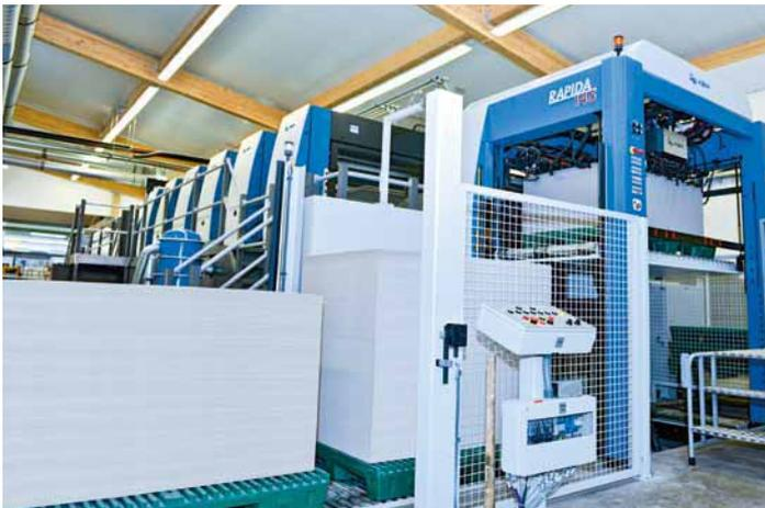
Die höher gesetzte Rapida-Anlage ist in eine automatisierte Logistik integriert
