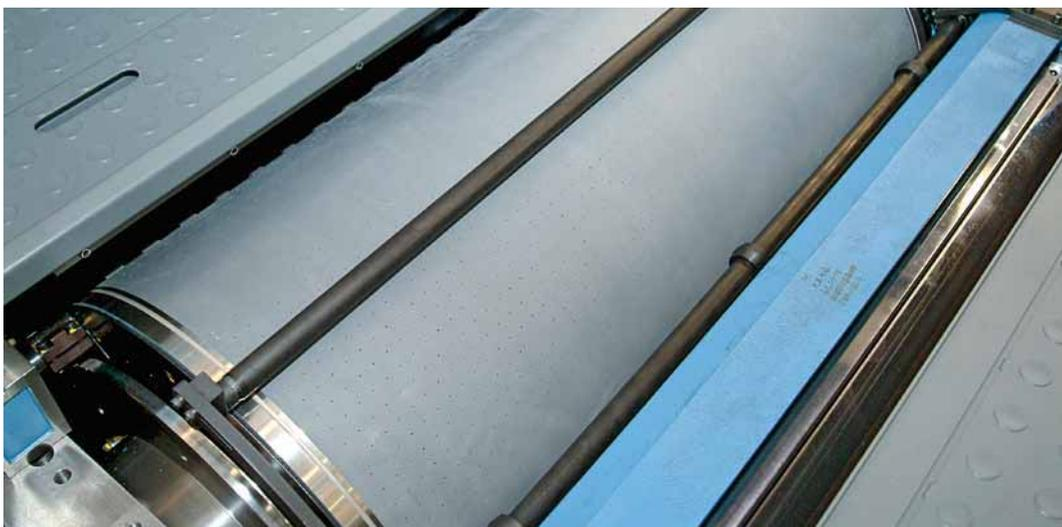
Die KBA AirTronic Drum ermöglicht den effizienten Einsatz der Inert-Trocknung an Rapida-Bogenoffsetmaschinen. Der Bogen wird angesaugt und hebt dadurch am Bogenende nicht ab und schlägt nirgendwo an
