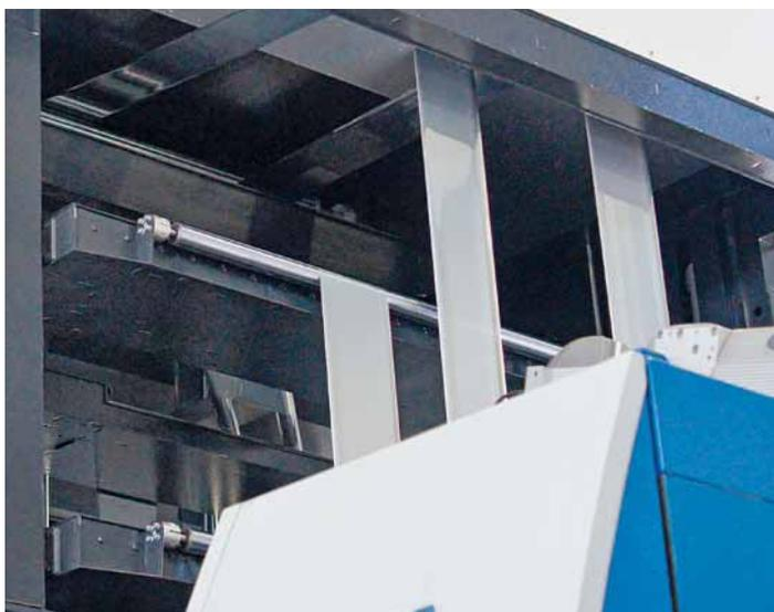
Bahnsplitting – hier in drei sujetgenau einlaufende Stränge – ist eine der beiden Materialspar-Optionen an der KBA ColdFoil Infigo SF110
