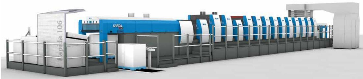
Die Rapida 106 mit zehn Farbwerken, Doppellacktechnologie und Kaltfolienveredelung sorgt demnächst in der Druckerei Yuri Gagarin im bulgarischen Plovdiv für brillante Effekte im Verpackungsdruck
