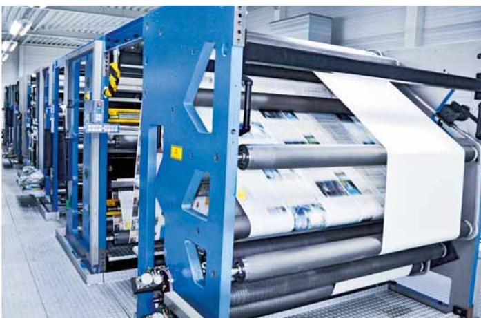
Der Rotationsüberbau ist mit zahlreichen Wendeeinrichtungen und Klebeköpfen für eine maximale Produktvielfalt ausgestattet
