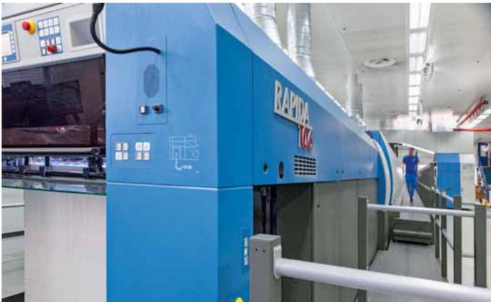
Bei der Maschinenlänge kommen einige Meter zusammen, die die Drucker pro Schicht zwischen Anleger und Auslage laufen. Im Hintergrund ist auch das Kaltfolienmodul erkennbar
