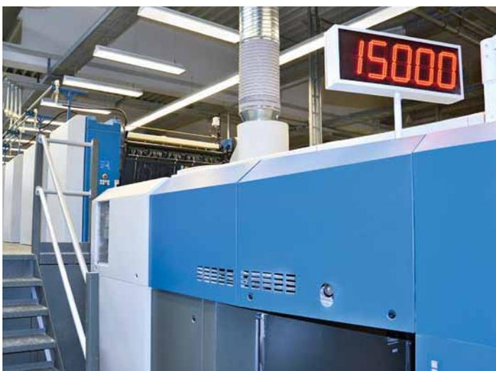
Mit zu 15.000 Bogen/h im 4 über 4-Druck erreicht die lange Großformat-Rapida die Leistung moderner Mittelformatmaschinen
