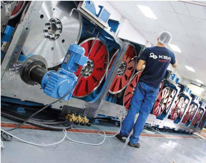
Nach dem Zusammenfügen der Unterbau-Boxen beginnt das Aufsetzen der Druckwerke
