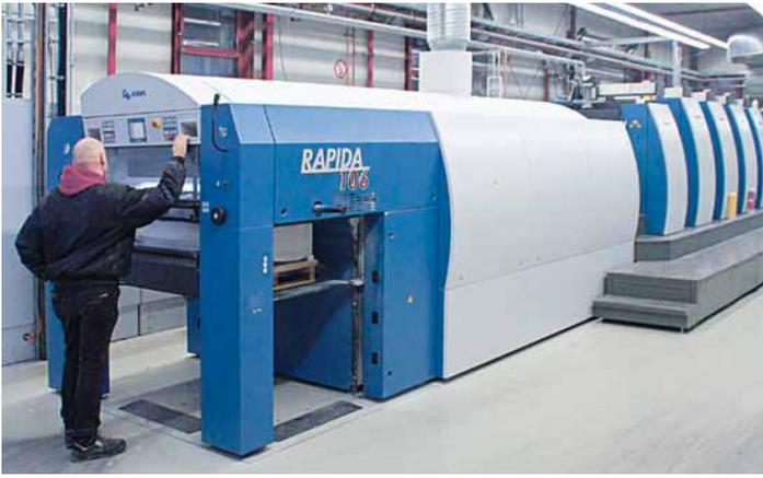
Die 2011 installierte KBA Rapida 106 verfügt über das Farbmess- und -regelsystem KBA QualiTronic ColorControl plus System Brunner Instrument Flight
