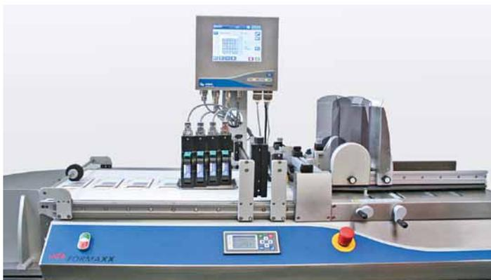
Im Verbund mit dem Vereinzlungssystem udaFORMAXX ist der betaJET verso bestens geeignet für die Kennzeichnung von Faltschachteln, Zuschnitten und Umkartons
