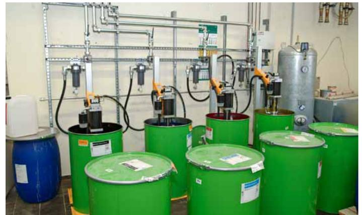
Wie es sich gehört: Die Achtfarben ist mit einer automatischen Farbversorgung ausgestattet, damit stets frische Farbe zur Verfügung steht und das Personal sich voll auf den Druck konzentrieren kann
