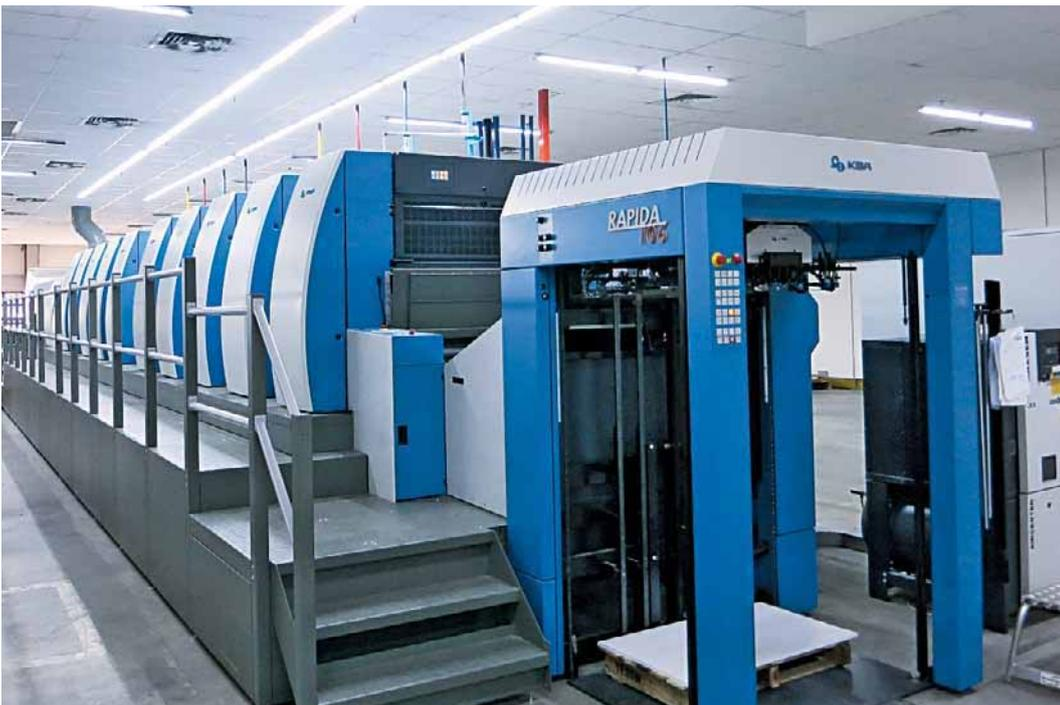
Die neue Zehnfarben-Wendemaschine KBA Rapida 106 ist die zweite KBA-Installation in kurzer Zeit am TWP-Standort Johor Bahru
