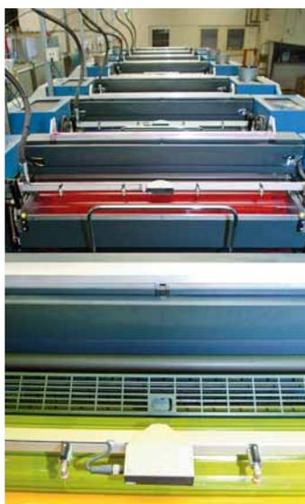
Zweimal vier Farben und dazu einseitige Lackierung bieten Werbedruck Aug. Lönneker mit nur einer Bogenoffsetmaschine höchste Flexibilität
