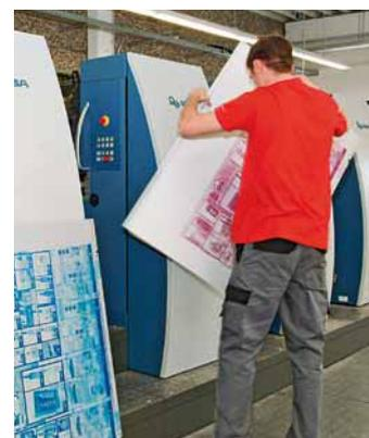
Während der Produktion bestückt Marcus Laubach die Wechselschächte mit den Druckplatten des Folgeauftrages
