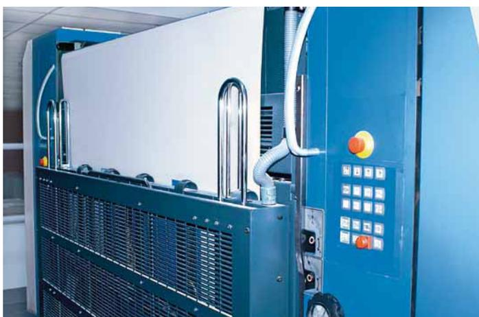
FAPC-Plattenwechsellautomaten ermöglichen einen schnellen Auftragswechsel
