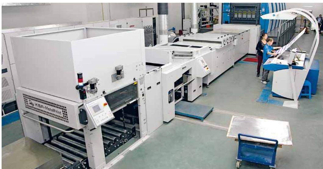
Das Foto zeigt die bereits in 2012 installierte Linie: eine 6-Farben-UV-MetalStar PR mit SMS und High-Speed-Stacker
