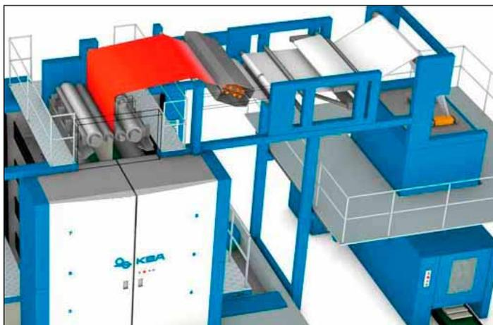
Lackierwerk und Trocknerhilfe im Überbau der KBA Cortina
