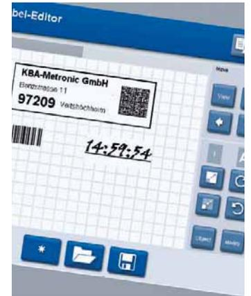
Ein farbiges 8,4" Touchscreen-Display ermöglicht eine komfortable Bedienung
