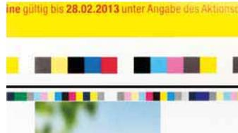
Messfelder-Set für Instrument Flight an der Rapida (oben, jetzt auch 3 x 3 mm), System-Brunner-Streifen für QuadTech CCS im Heatset (unten)
