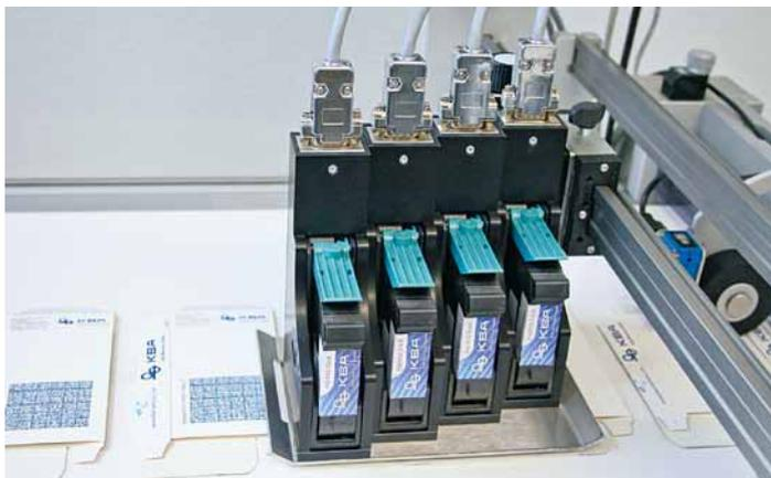
Bis zu vier frei kaskadierbare Druckköpfe d. h. Druckbreiten bis zu 2" (50,8 mm) sind möglich
