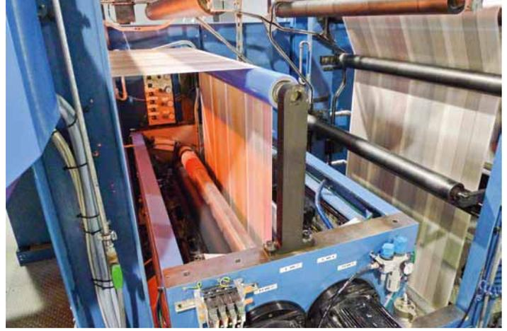
Blick von oben in das direkt über dem Cortina-Druckturm angeordnete Doppel-Lackwerk für beide Papierbahnseiten
