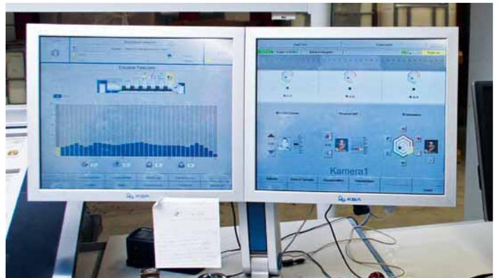
Auf den beiden Touchscreen-Monitoren aktiv sind rechts der Instrument Flight Balance Navigator mit seinen Hexagon-Farbraumdiagrammen und links die Stellung der Farbschieber, samt Empfehlung zum Gummituchwaschen
