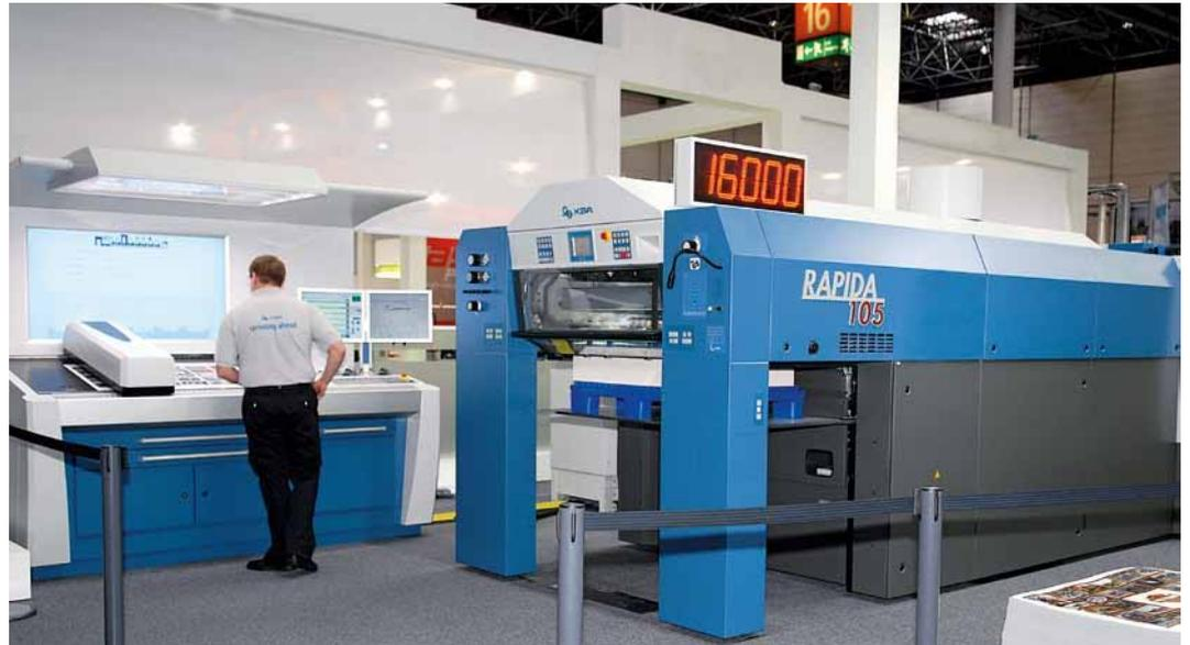
Der hochmoderne ErgoTronic-Leitstand der Rapida 105 mit integrierter Messtechnik
