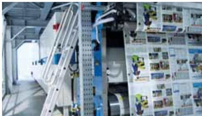
Cette bande de papier SC, ici à la sortie d'un des quatre sécheurs heatset, va être réunie dans la superstructure de la plieuse avec les bandes imprimées en coldset sur papier journal
