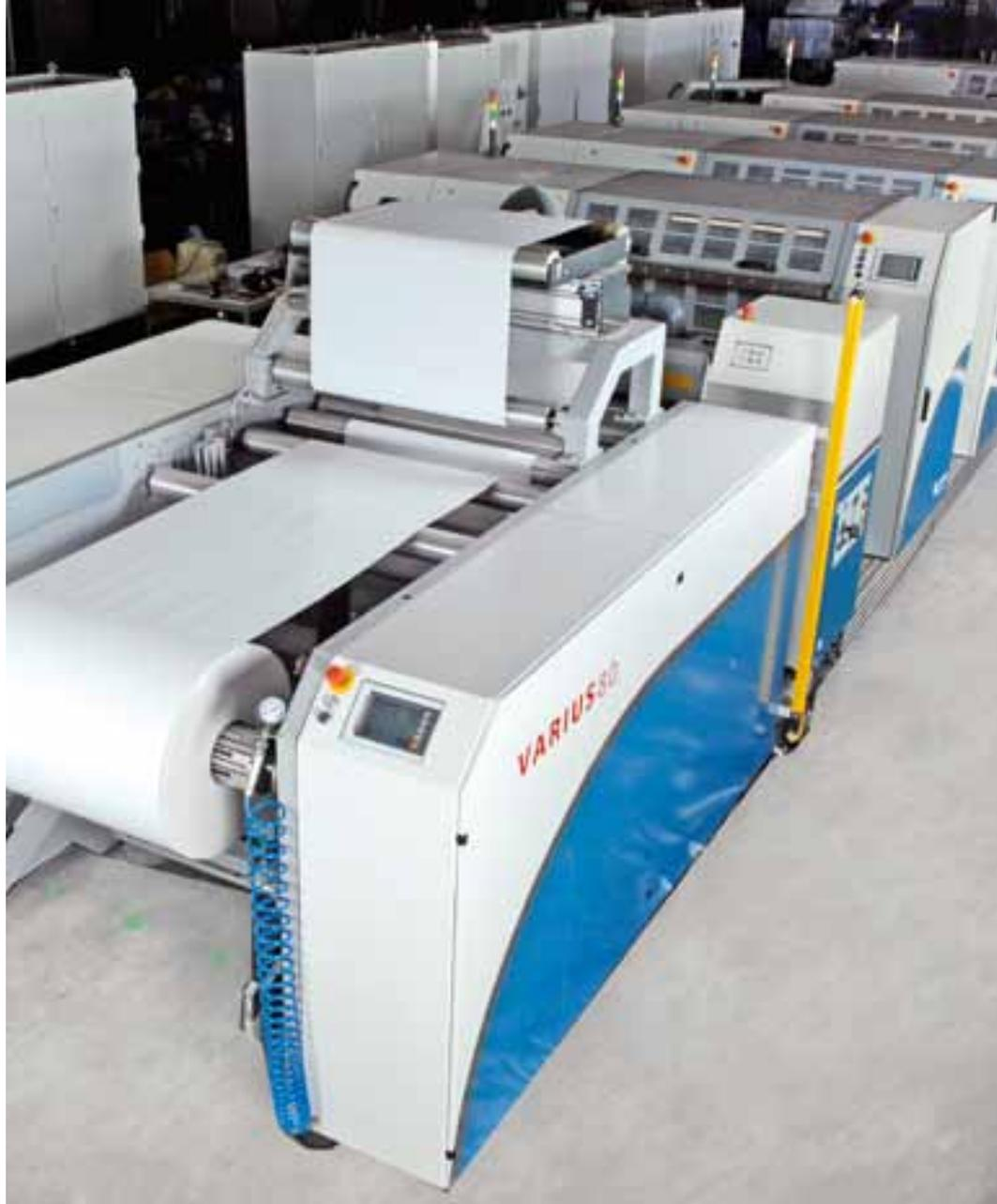
De conception modulaire, la rotative Varius 80 à format variable dédiée à l'emballage peut être configurée en fonction des spécificités de la production. Vue de l'ensemble de la machine à partir du dérouleur
