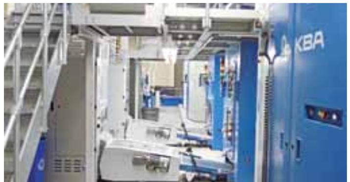
Les deux plieuses à mâchoires et les stations de transfert desservant les convoyeurs à pinces Ferag sont positionnées entre les quatre tours d'impression
