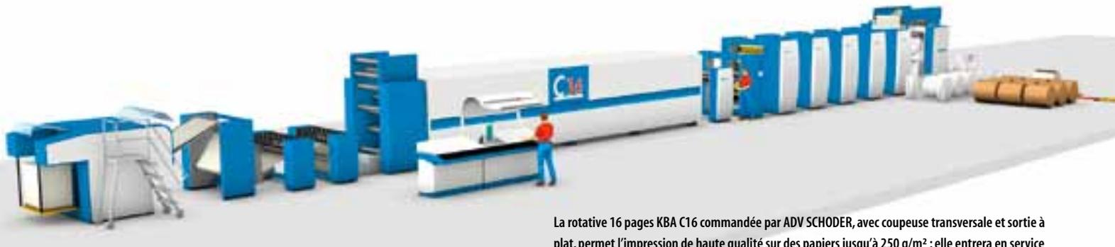
La rotative 16 pages KBA C16 commandée par ADV SCHODER, avec coupeuse transversale et sortie à plat, permet l'impression de haute qualité sur des papiers jusqu'à 250 g/m<sup>2</sup> ; elle entrera en service en décembre 2012
