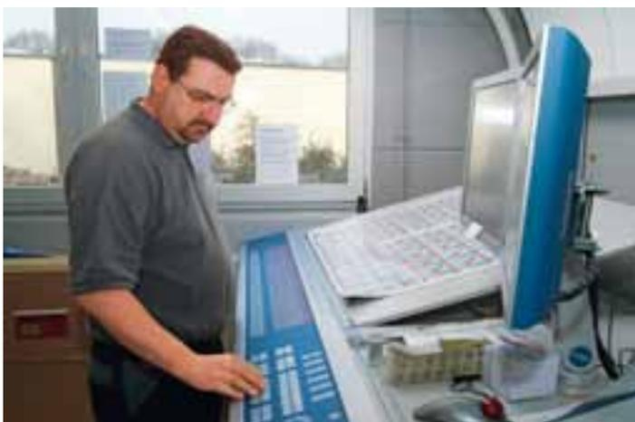
Pour l'impression d'étiquettes, il est particulièrement intéressant de pouvoir enregistrer toutes les données d'une commande sur le pupitre de la machine en vue des remises sous presse. Quasiment aucun réglage manuel ne sera alors requis sur le margeur ou la réception
