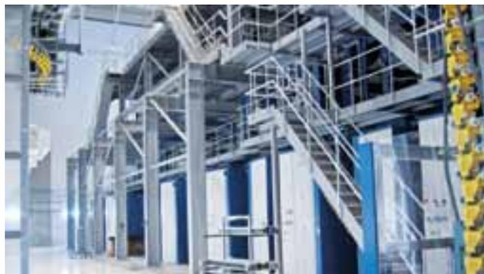
L'une des trois sections de la machine avec quatre tours d'impression compactes et deux sécheurs à air chaud sur chacune des sections aux extrémités
