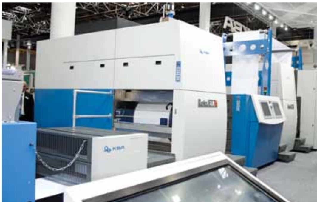
La RotaJET a bénéficié de toute l'expertise de KBA en matière de construction de machines d'imprimerie, notamment pour le guidage du papier et le contrôle de la tension de la bande
