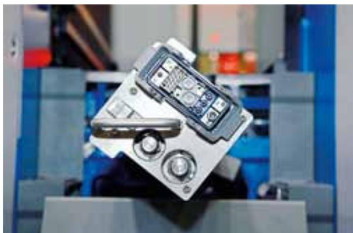
En haut : le module LED UV de la Rapida 105 s'insère facilement dans les emplacements prévus pour les cassettes-tiroirs des modules UV conventionnels
