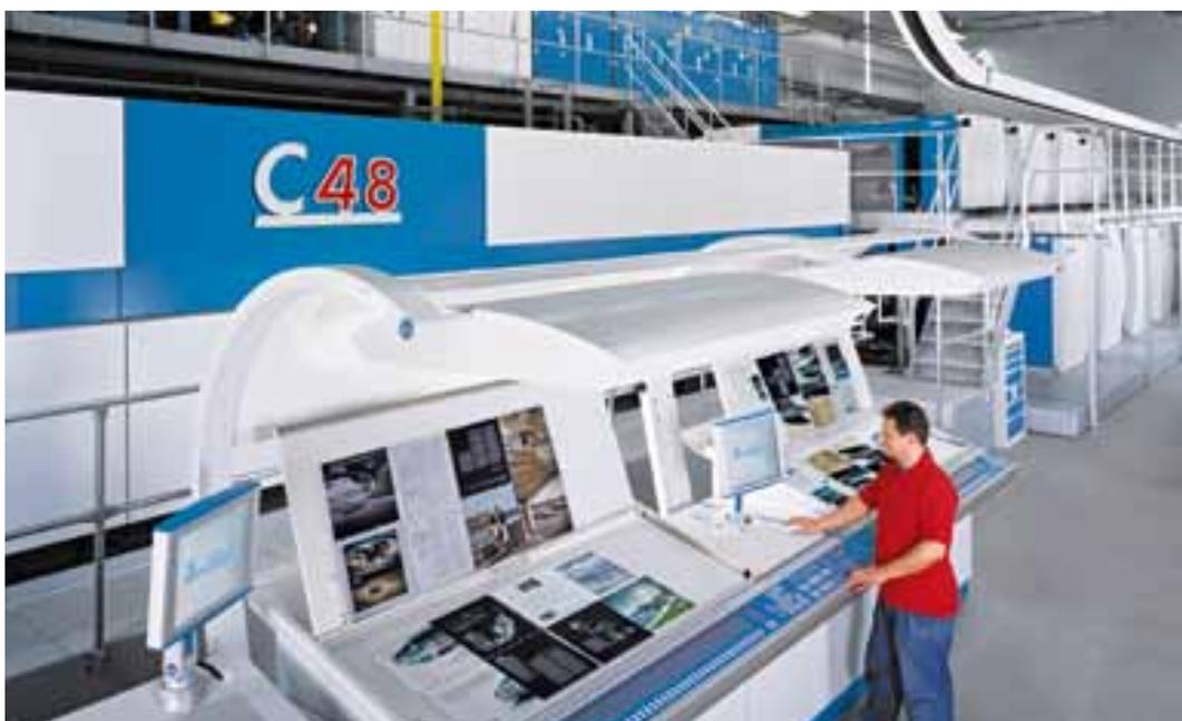
Souplesse de production hors du commun et possibilité de fabrication en ligne font de la rotative labeur 48 pages KBA C48 associée à la plieuse V5 à format variable une machine très appréciée aussi pour l'impression d'édition grand volume
