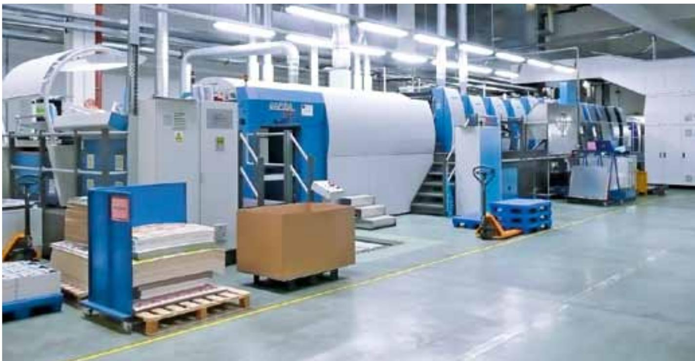
La nouvelle Rapida 106 de Model Obaly est équipée de nombreux composants d'automatisation et options d'ennoblissement. À l'arrière-plan, le module Vinfoil pour pelliculage à froid
