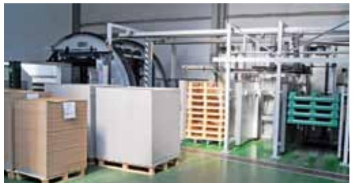
Un retourneur de pile transfère les piles des palettes de transport sur les palettes système
