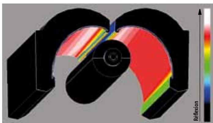
La forme optimisée des réflecteurs et l'utilisation rationalisée de la chaleur des émetteurs améliorent le rendement énergétique lors du séchage
