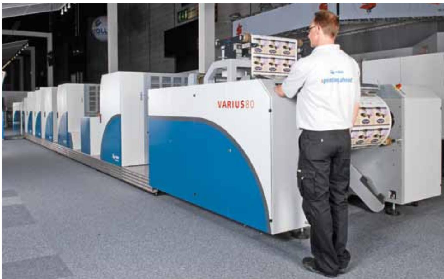
Avec une laize maximale de 800 mm et une vitesse d'impression de 400 m/minute, la Varius 80 peut passer des supports de 30 µm à 800 µm d'épaisseur, avec une longueur d'impression variable de 21" à 34"
