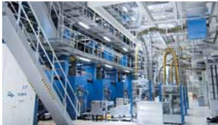
Avec douze tours d'impression, autant de dérouleurs, trois plieuses et quatre sécheurs à air chaud, la ligne KBA Cortina impressionne les visiteurs du nouveau centre d'impression par sa qualité d'impression comme par ses dimensions
