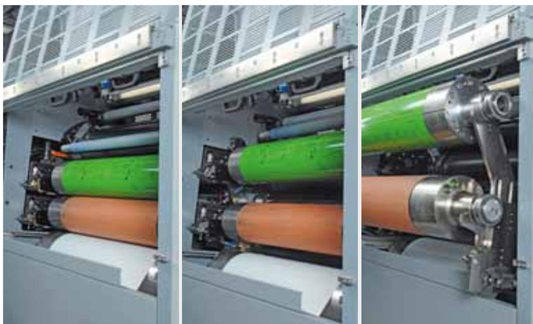
Le changement de format s'effectue en quelques minutes : cylindres porte-plaque et porte-blanchet sont remplacés automatiquement. En attendant le travail suivant, les cylindres sont placés dans un magasin côté entraînement
