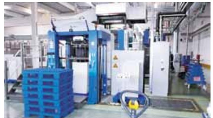
Le margeur de la machine rehaussée est équipé d'une logistique des piles automatique
