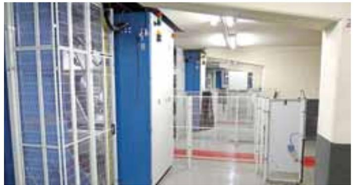
Les dérouleurs, eux aussi adaptés précisément à l'atelier, ont été munis des grilles de protection imposées par les règlements de sécurité du fait des dimensions des bobines et mandrins de la rotative triple laize
