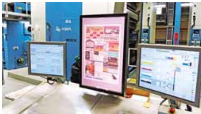
L'un des trois pupitres ErgoTronic de la Commander CT : à gauche, l'écran de contrôle du repérage, au milieu le moniteur de prévisualisation de l'épreuve et l'écran tactile pour la commande de la machine
