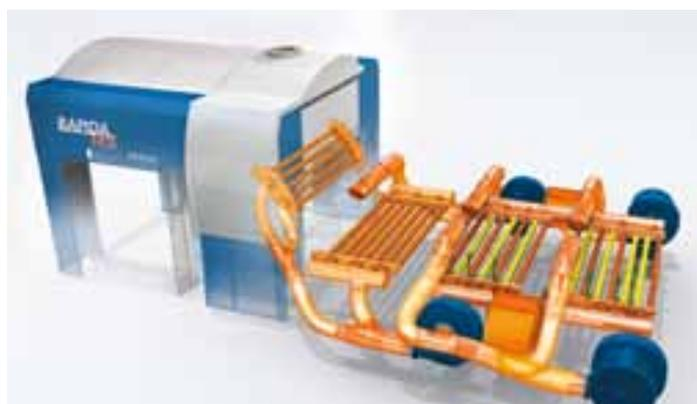
Le recyclage de l'air pulsé utilisé pour le séchage permet de réduire considérablement la consommation électrique des sècheurs à infrarouges/air chaud KBA VariDry<sup>BLUE</sup> par rapport aux sècheurs à infrarouges/air chaud classiques
