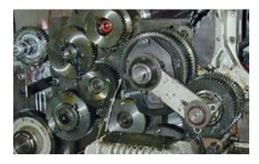
Bei einer konventionellen mechanischen Kupplung ist die Schlupfeinstellung aufwändig und ungleichmäßig. Die Antriebszahnräder unterliegen damit erheblichen Belastungen und Verschleiß. Die pneumatische Rutschkupplung ersetzt die starren mechanischen Verbindungen zwischen Hauptgetriebe, Hartgusszylinder und Lackierzylinder.
