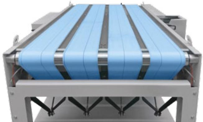
eine stets gleichmäßige Riemenspannung gewährleistet, sondern auch ein stets konstanter Abstand der Einlaufwelle zur vorhergehenden Arbeitsstation. Das erhöht die Produktionssicherheit nochmals erheblich. Darüber hinaus werden die neuen Transportriemen nicht mehr geklebt, sondern werden einfach mit einer Spiralnaht verbunden. Dadurch reduziert sich die Rüstzeit um bis zu 85 %.
