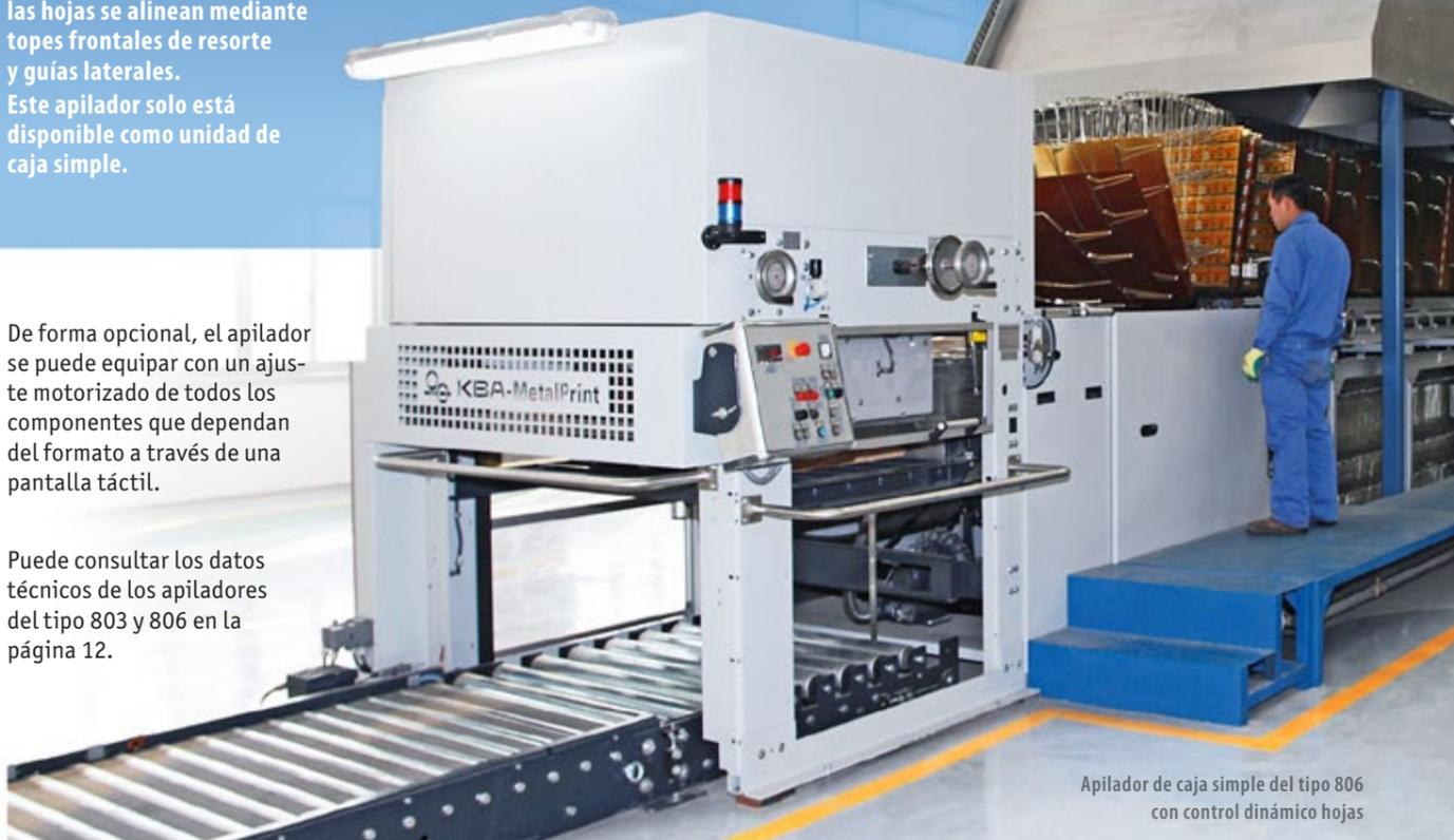
Apilador de caja simple del tipo 806 con control dinámico hojas
