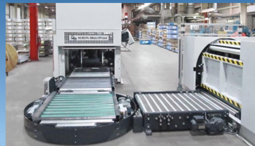
Transportador de rodillos con mesa de giro y volteador de pilas inline del tipo 821
