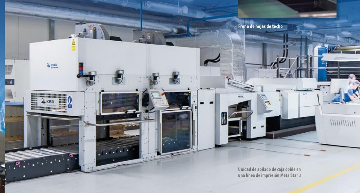
Unidad de apilado de caja doble en una línea de impresión MetalStar 3
