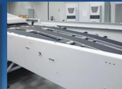
Transportador de cinta ancha como compensación de altura
