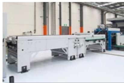
Transportador de puente con alineación adicional del borde delantero en combinación con un alimentador intermedio (visto desde el lado de accionamiento)
