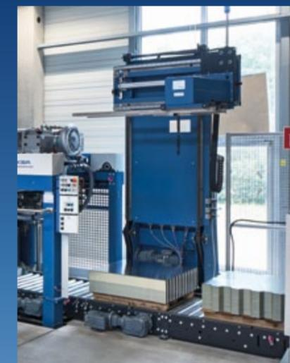
Cambiador semiautomático de palés del tipo 775 para el alimentador 780 en líneas de barnizado
