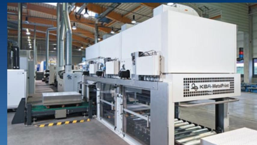
Unidad de apilado de caja doble con apilado de maculatura adicional y transportador de cadena lateral
