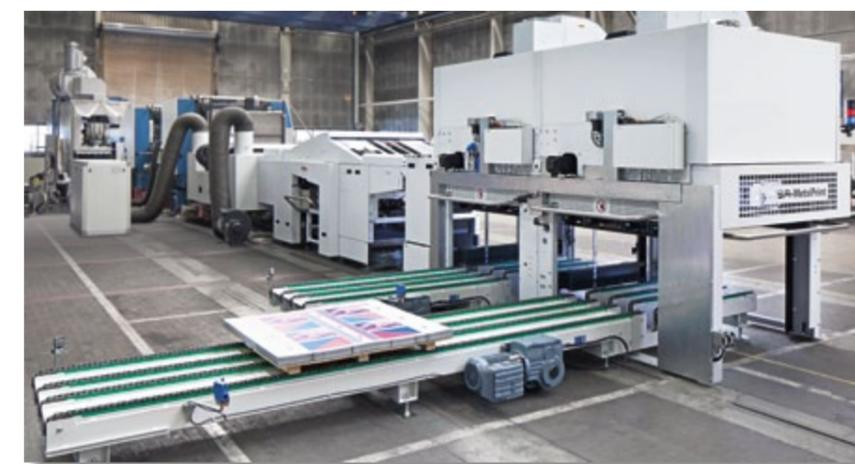
Retirada de pila opcional mediante transportador de cadena lateral
