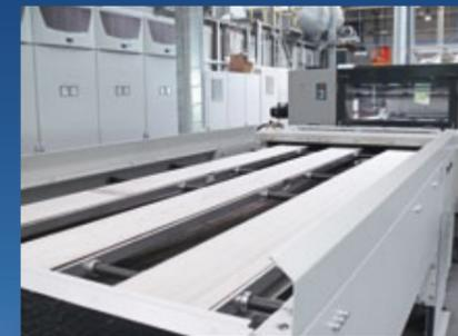
Transporte de hojas con cintas especiales resistentes a UV tras un secador posterior UV
