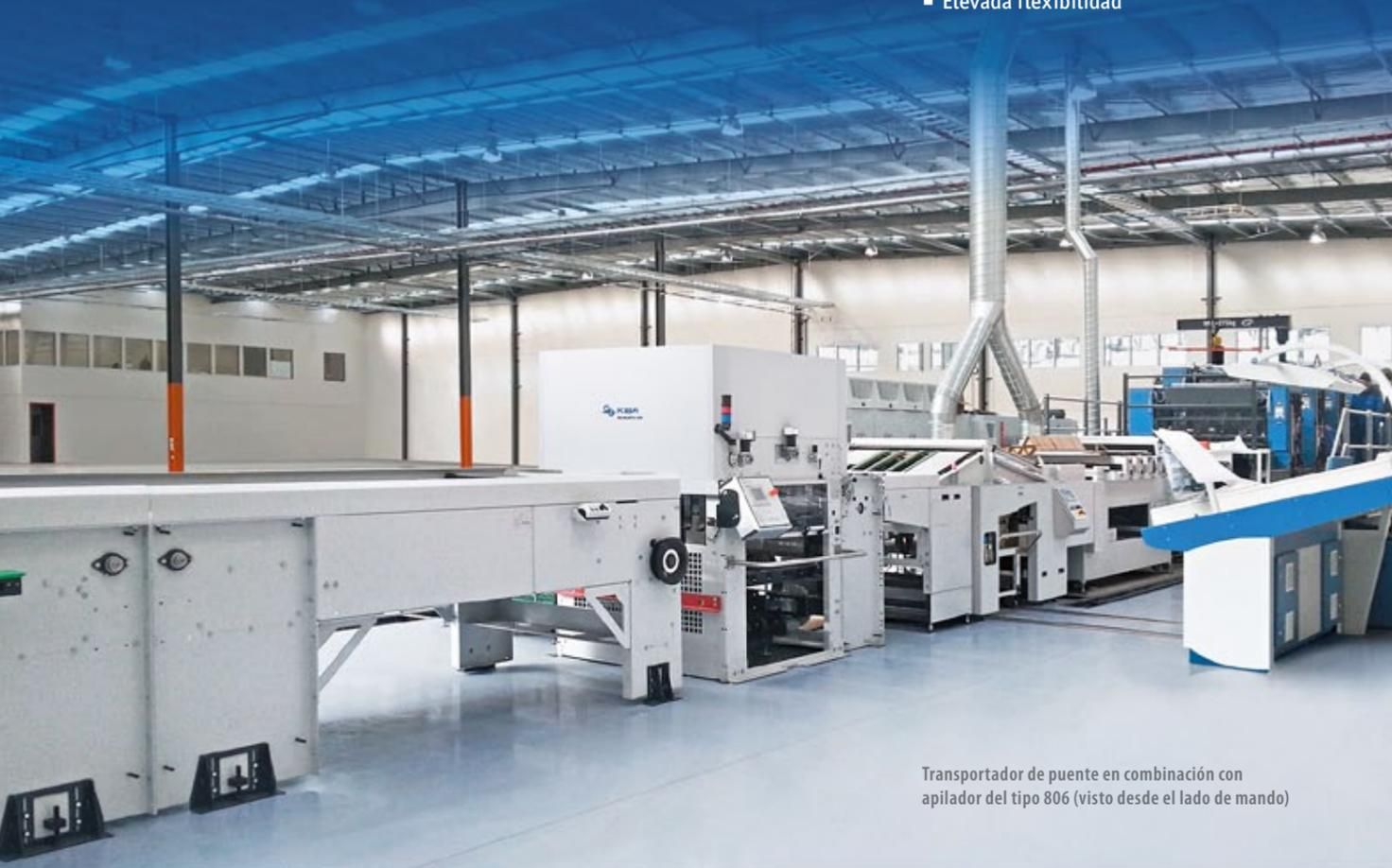
Transportador de puente en combinación con apilador del tipo 806 (visto desde el lado de mando)
