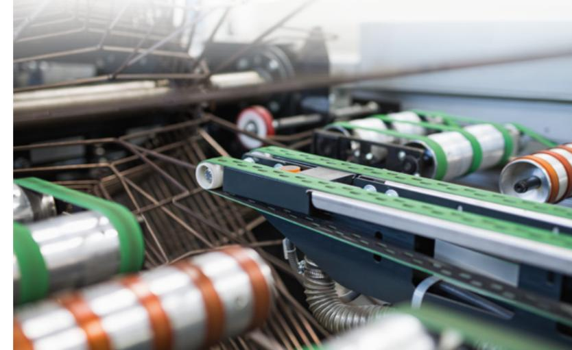
Dopo essere stato appoggiato alla fine del forno continuo, è fondamentale che il foglio asciutto venga trasportato con rapidità e in assoluta sicurezza. Lo garantisce in modo eccezionale l'acceleratore dinamico. I fogli vengono accelerati alla velocità di trasporto da una tecnica sottovuoto all'avanguardia senza slittare. Anche a velocità di produzione elevate, il foglio viene mantenuto in posizione con sicurezza. In questo modo si evitano graffi e danni sui bordi dello stesso.
