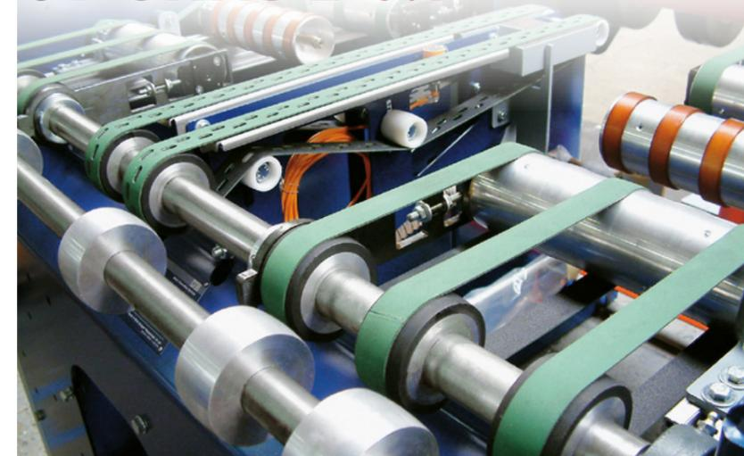
Il freno a cinghia intermittente rallenta i fogli in modo assolutamente sicuro e senza slittamento e garantisce il preciso trasferimento dei fogli ai telai metallici. Anche ad elevate velocità di produzione, i fogli vengono mantenuti in posizione da una modernissima tecnica sottovuoto. Un convertitore di frequenza e vari sensori controllano il processo di rallentamento. Utilizzando cinghie, questo sistema è pressoché non manutentivo.
