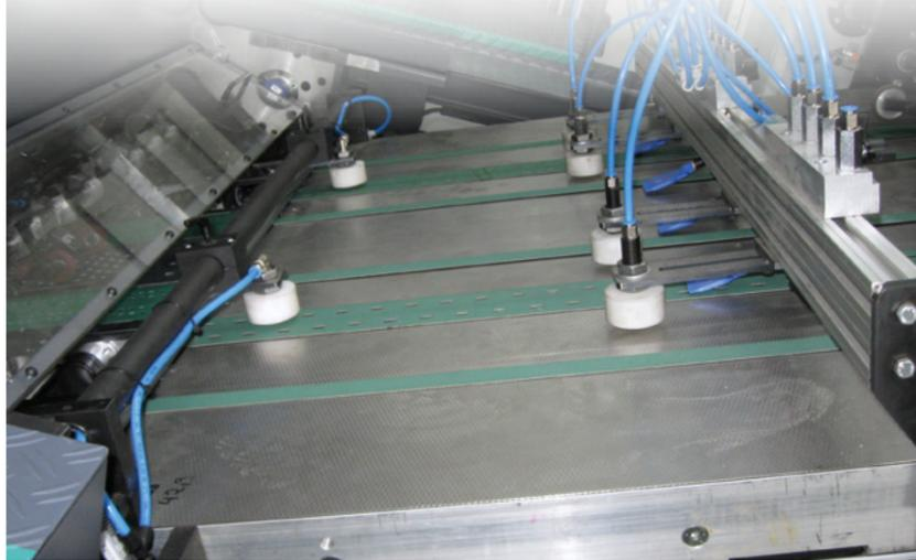
Die einlaufende Tafel wird durch getaktete Luftzufuhr angehoben. Dadurch wird eine reibungslose, nahezu berührungsfreie Trennung von der nachfolgenden Tafel erreicht.
